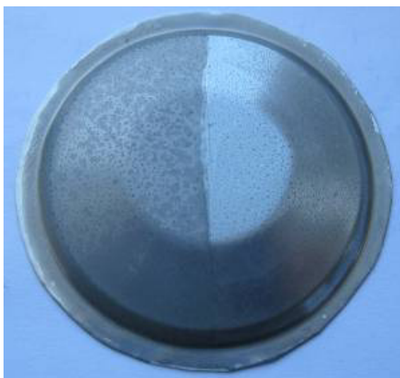
Рисунок 2.5. Влияние ИПП на коррозионную стойкость нержавеющей стали в парах соляной кислоты: левая половина была экранирована от воздействия НСЭП, правая половина обрабатывалась НСЭП в стандартных режимах.
