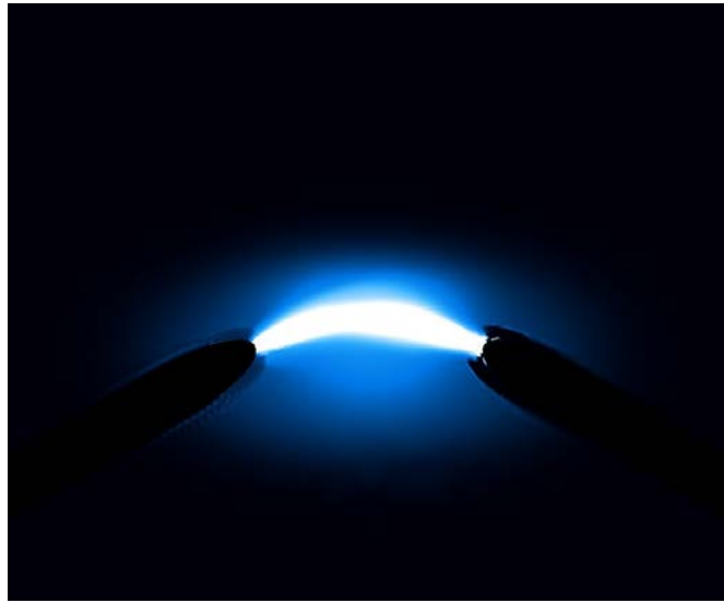
Рисунок 5.4 — Квазистационарная структура плазменного канала
