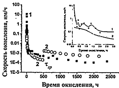
Рис. 2.18. Зависимости скорости окисления от времени окисления для образцов после РИТ (1) и после обработки в АВ при T = 400^\circ\text{C} в течение 10 мин, затем при T = 100^\circ\text{C} в течение 0.5 мин (2).
