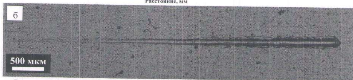
Рисунок 14 – Зависимость сигнала акустической эмиссии от нагрузки и глубины проникновения индентора в покрытие (\text{Zr}+\text{TiBSiNi})\text{N} , полученного с применением источника ПИНК (а), соответствующее изображение дорожки износа покрытия (\text{Zr}+\text{TiBSiNi})\text{N} после скретч-испытания (б)
