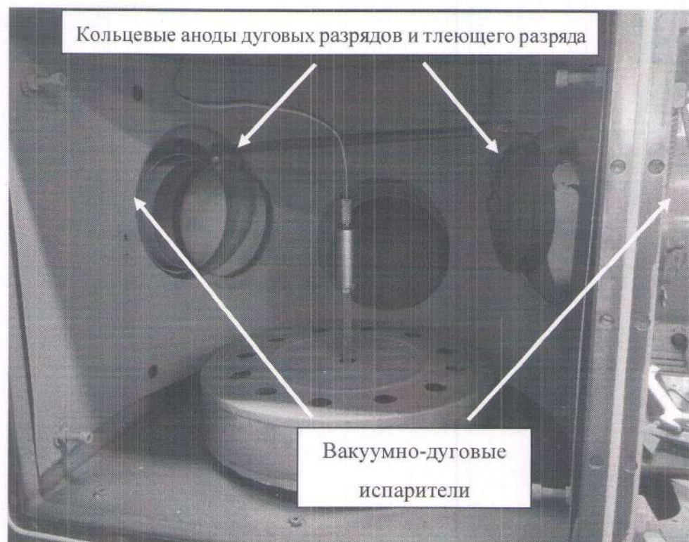
Рисунок 4 – Внешний вид кольцевых анодов тлеющего и дуговых разрядов в экспериментальной установке
