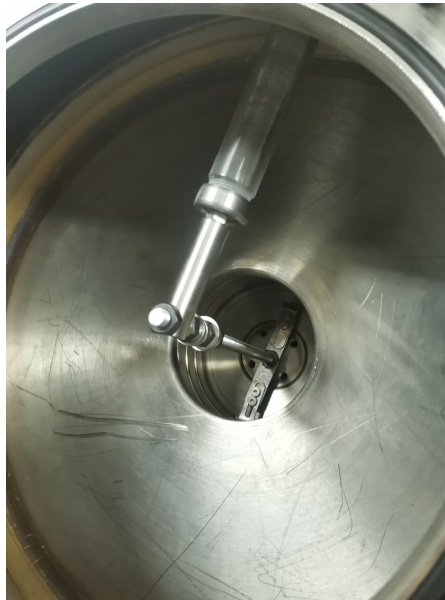
Рис. 3. Фотография измерительной сборки, установленной в вакуумную камеру.
