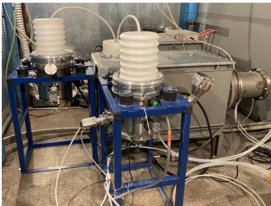
Рис. 2. Генератор с двумя камерами для электроимпульсного дробления.
