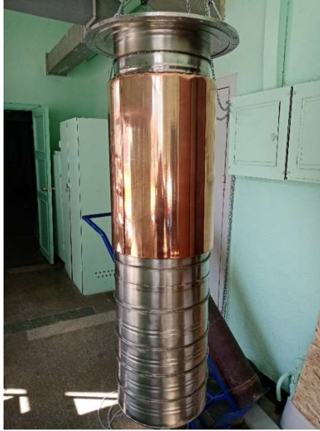
Рис. 1. Внутренний сосуд криостата с азотным экраном.
