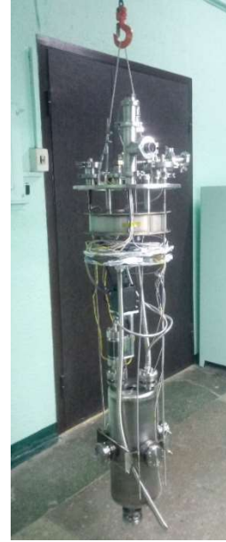
Рис. 2. Резонатор в сборке с вводом мощности и полевой антенной с креплением к крышке погружного криостата.
