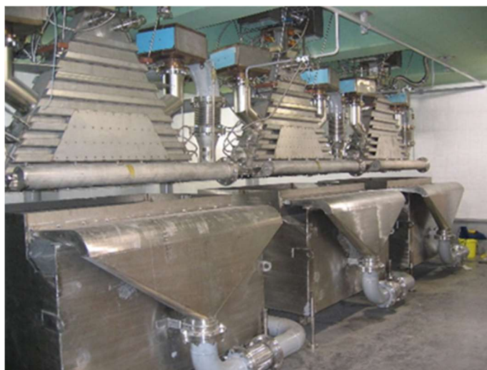
Рис. 8. Зал электронно-лучевой обработки сточных вод красильного производства в г. Тэгу (Южная Корея).
