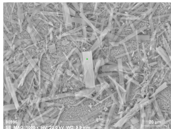
Рис. 6. РЭМ изображение поверхности ( 130 \times 100 мкм) агломерации порошковых частиц, полученных при эрозии материала в результате воздействия внешнего источника тепла.
