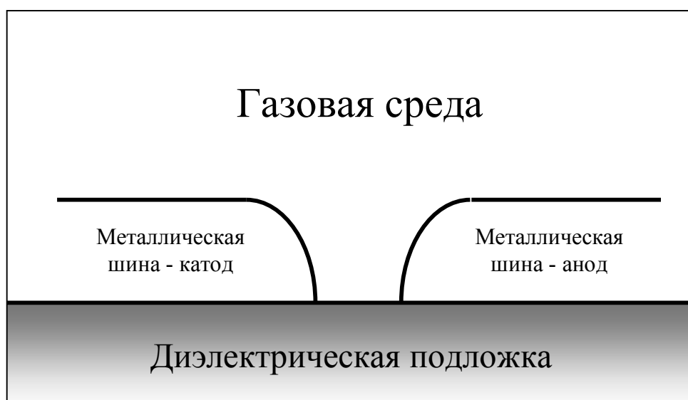
Рисунок 1.3 – Модельная геометрия разрядного промежутка
