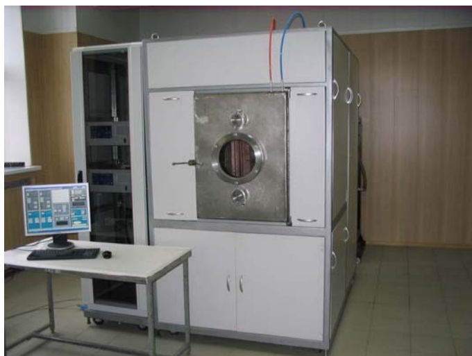
Рис. 11. Внешний вид автоматизированной вакуумной установки для ионно-плазменного нанесения покрытий.
